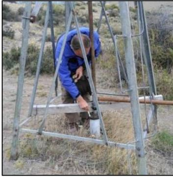
Figura 3-35. Medición de profundidad del nivel de agua en Molinos de Estancias.
