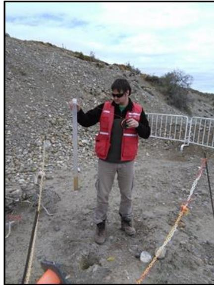
**Figura 3-41. Toma de muestras de pozos mediante bailer, para medición de parámetros in situ.**
