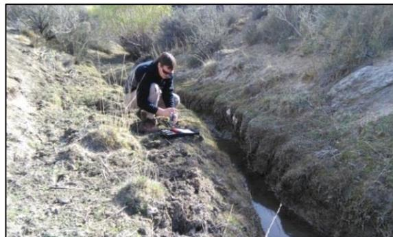
Figura 3-40. Medición de parámetros in situ: pH, CE y  $T^{\circ}$  en curso del cañadón El Mosquito.
