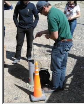
Figura 3-36. Medición de profundidad del nivel de agua en pozos geotécnicos existentes.
