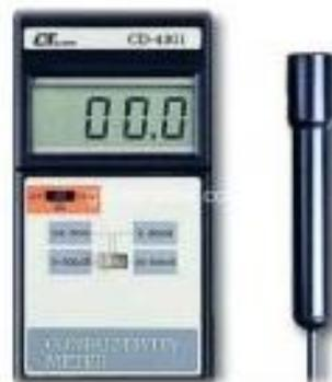
Figura 3-3. Conductímetro para medición de campo.
